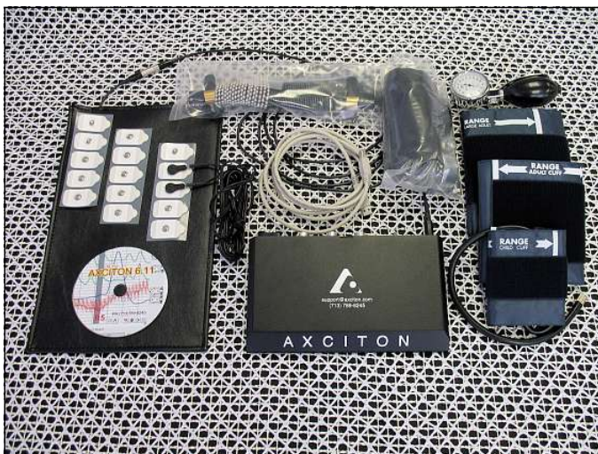
Abb. 1 Ausstattung eines herkömmlichen Polygrafen: Elektrodermale Elektroden sollen die Hautleitfähigkeit messen. Zur Messung des Blutdrucks liegen Manschetten in verschiedenen Größen bei, hier für Kinder, Erwachsene und kräftige Erwachsene. (Quelle: Asciton Systems, mit Genehmigung)
